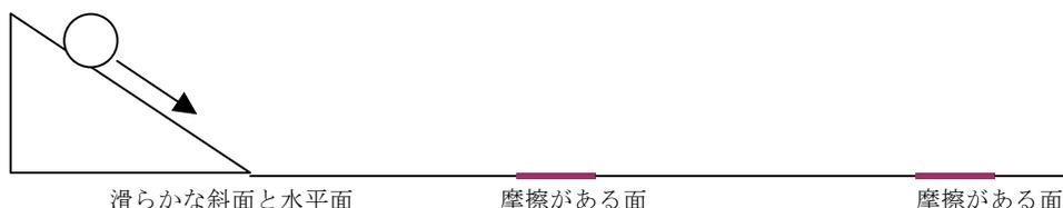
斜面の上から球を静かに放すと球は斜面を滑り落ちて滑らかな水平面上を等速直線運動する。摩擦のある面の上を通過するとき  $W = \mu' R x$  ( $\mu'$ は動摩擦係数、 $R$ は垂直抗力、 $x$ は面上を玉が移動する距離)の仕事を受けて減速する。二つの面の大きさは等しいとする。
