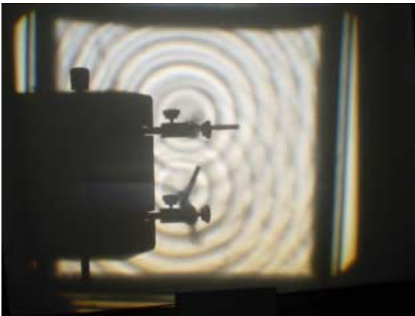
(図3) 位相差 \pi のときの干渉の様子
