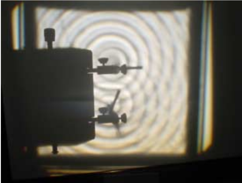
(図2) 位相差 \pi/2 のときの干渉の様子
